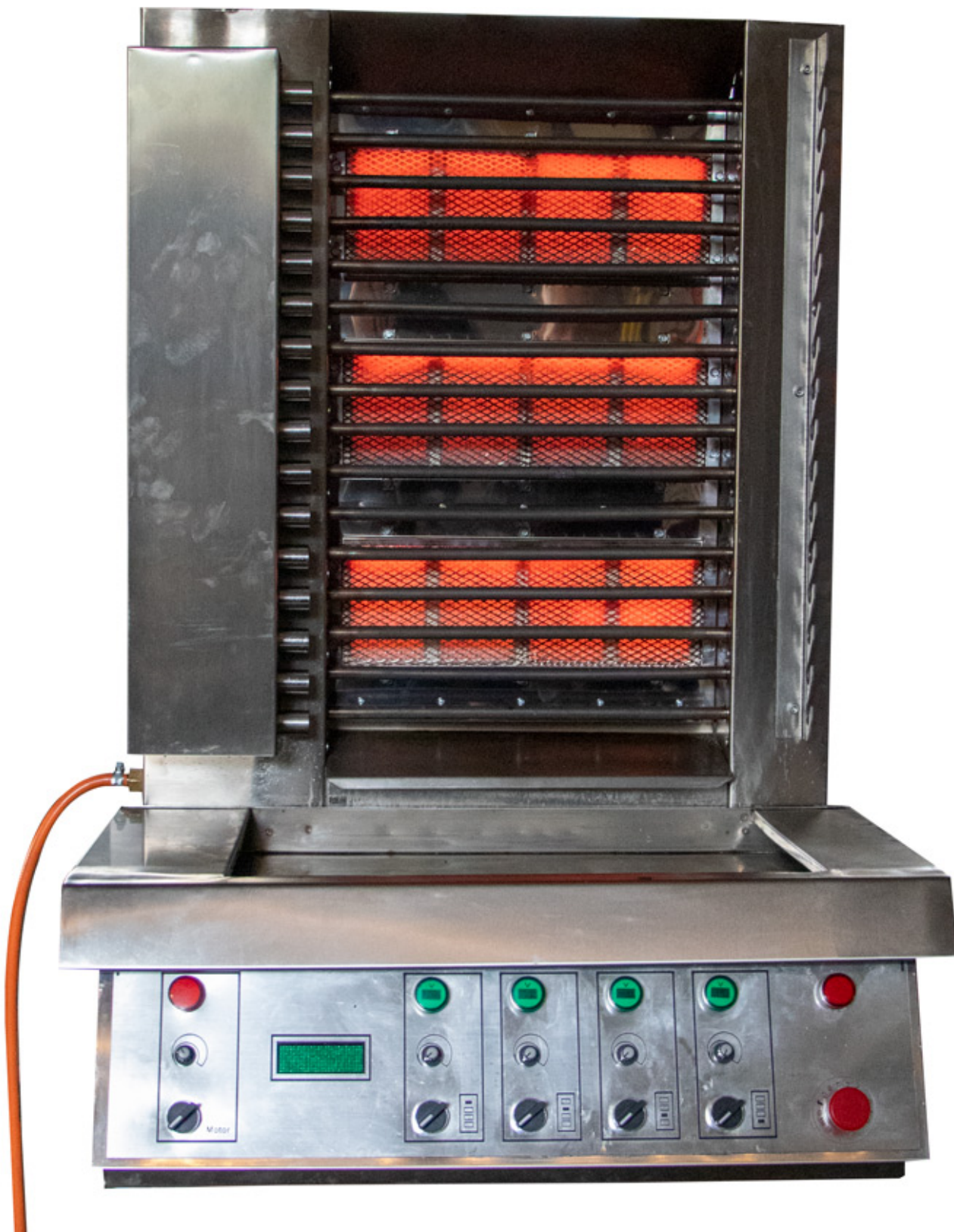
Кордиеритовые плитки, применяемые в газовом излучателе.
